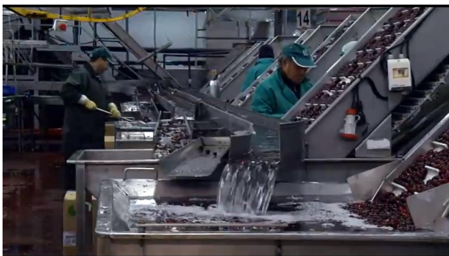
Figura 28: Sistema de hidrocooling en la Agrupación. Fuente: Canal Extremadura.
